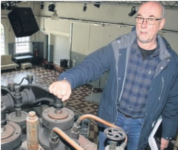
Manometer zeigten früher den Schmieröldruck in den Motoren an. Auch das Werkzeug ist zu sehen, das die Arbeiter brauchten, um die Motoren mit am Laufen zu halten. Wichtig waren dabei auch die großen Kipphebel zur Steuerung der Ventile.
