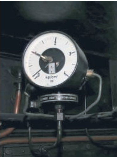
Manometer zeigten früher den Schmieröldruck in den Motoren an. Auch das Werkzeug ist zu sehen, das die Arbeiter brauchten, um die Motoren mit am Laufen zu halten. Wichtig waren dabei auch die großen Kipphebel zur Steuerung der Ventile.
